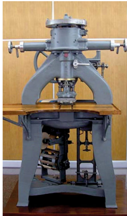
Rys. 1. Wykonana w Wielkiej Brytanii maszyna (prasa) drukująca „Johnston” (1919 r.) drukowała pojedynczy banknot z prędkością 550 cykli na godzinę. Ręczna maszyna dociskowa, w której arkusze podawane i odbierane są ręcznie, a ścieranie farby z powierzchni miejsc niedrukujących odbywa się za pomocą papieru (Banca d'Italia; Banknote Museum)
