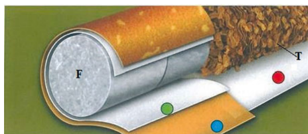
Rys. 1. Papierowa konstrukcja papierosa [1] T – tytoń, F – filtr, znak czerwony – bibułka, zielony – papier owijkowy, niebieski – papier ustnikowy
