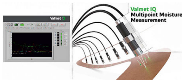
Rys. 2. Wielopunktowy pomiar zawartości wilgoci w systemie Valmet IQ [1]
